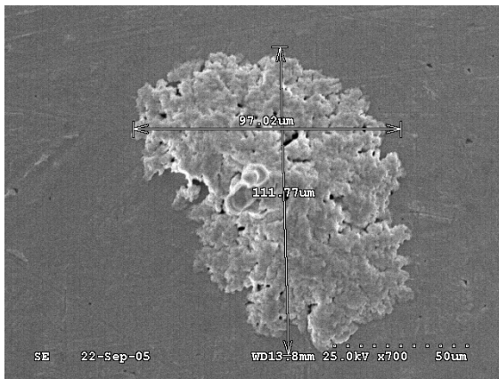
CU-U-2 06 Hillock surface – 112 um length and 97 um width
