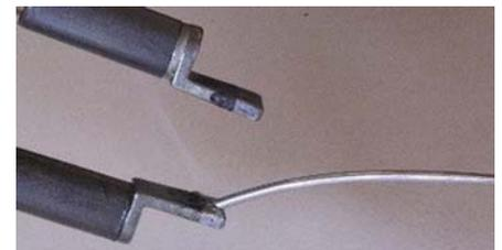
Figura 2 Estañar las Puntas con Soldadura.
